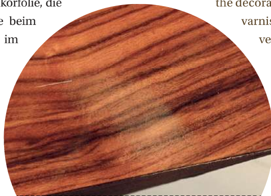
Helle Flecken sind ein Zeichen für Fehler im Furnier Light spots are a sign of faults in the veneer
